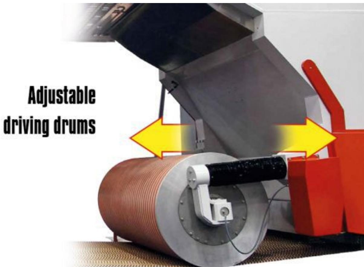
A Breton patenteou o posicionamento motorizado independente das duas polias guia-fio, que é proposto como opcional. Cada polia guia-fio pode se aproximar ao bloco em 60 cm.
