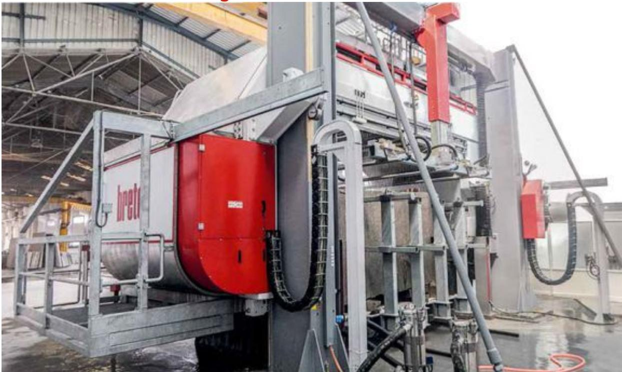
As polias e os tensionadores estão montados dentro de uma estrutura rígida fechada de aço que desliza ao longo das colunas de sustentação, rigidamente ancoradas ao
